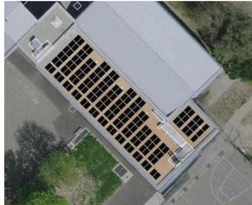
Figure 5 – Calepinage toiture A
