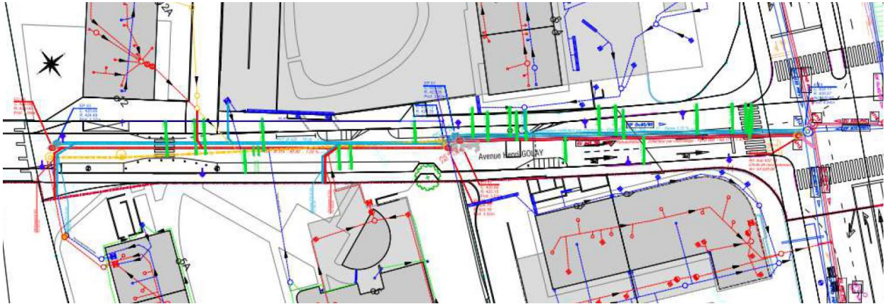
Figure 49 - Projet de mise en séparatif du réseau d'assainissement sous l'avenue Henri-Golay entre le pont CFF et l'avenue de Châtelaine
