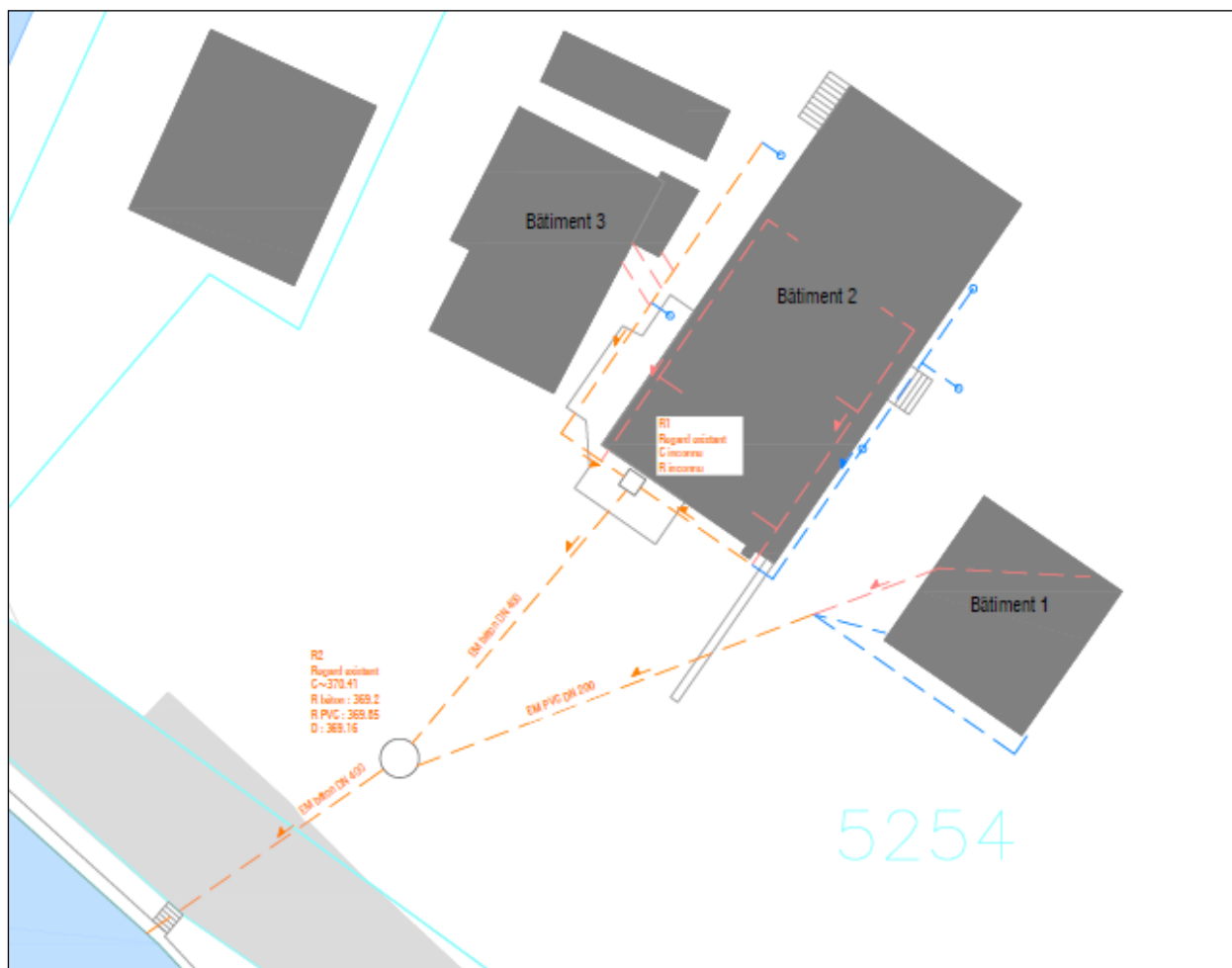
Figure 2. Système d'assainissement existant des 3 bâtiments situés « Au Moulin »
