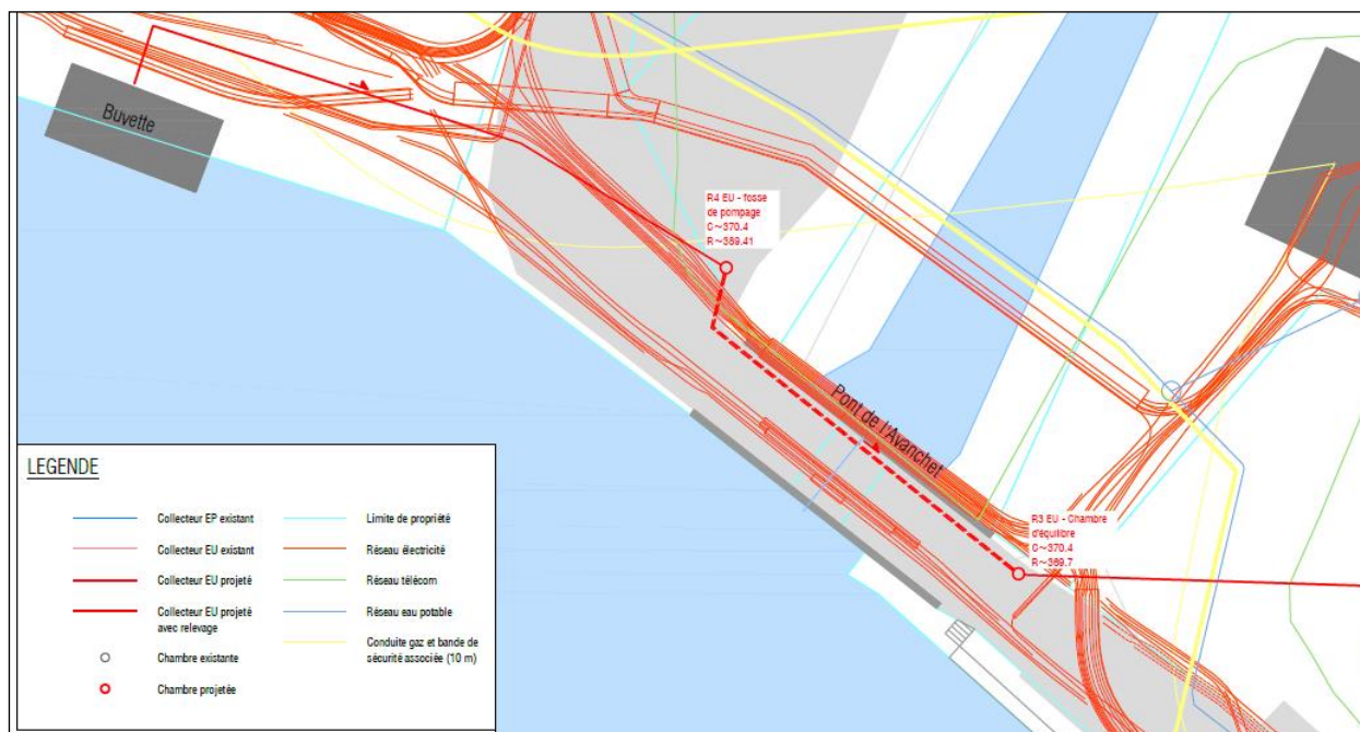
Figure 4. Réseau de collecte projeté et réseaux souterrains existants
