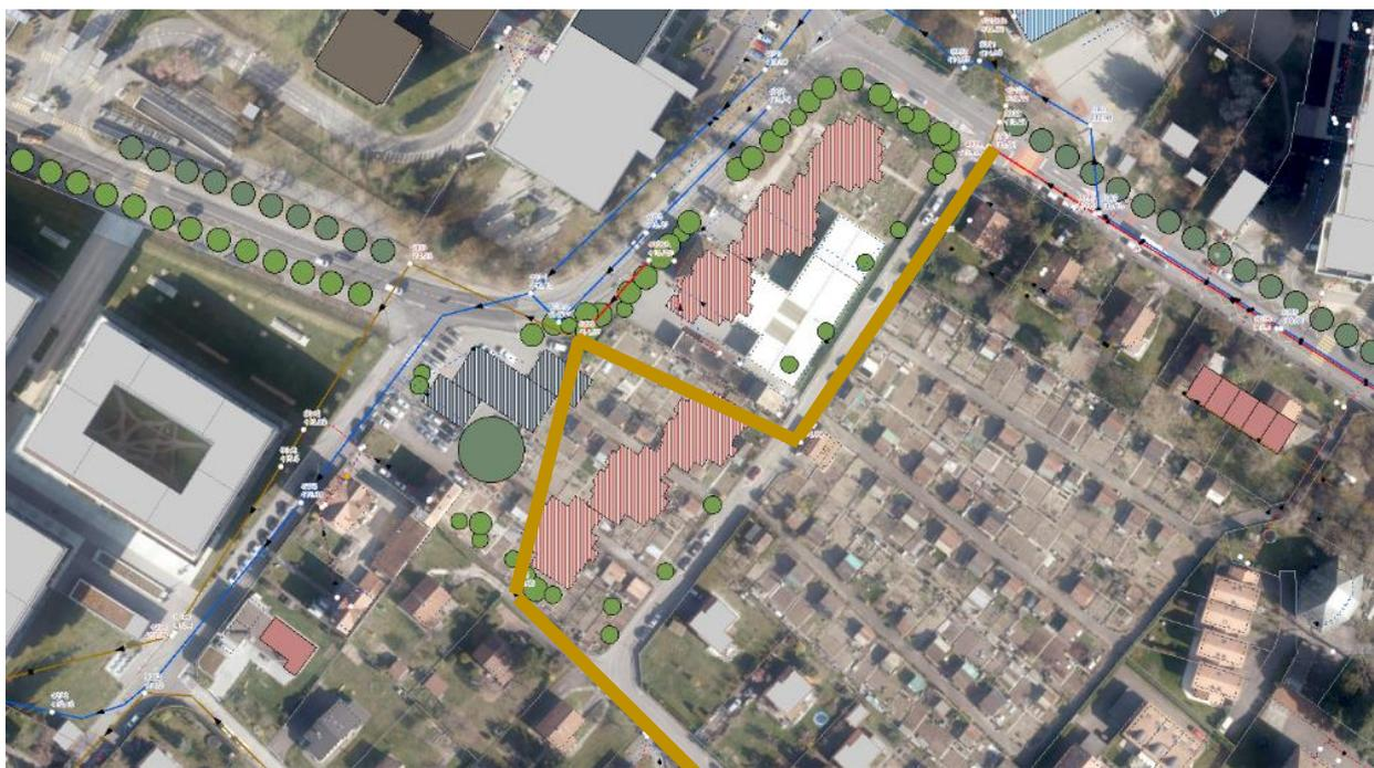
**Figure 1 - Superposition bâtiments lauréat et réseau d'assainissement Eaux Mélangées (EM) sur Henri-De-Buren**
